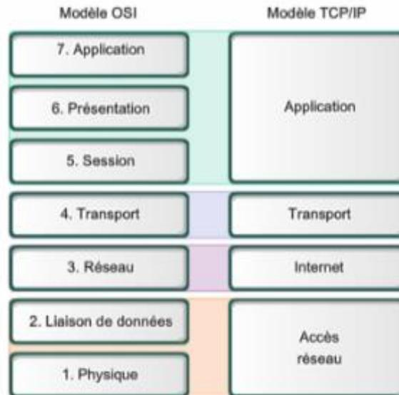
Figure 4: correspondance modèle OSI et modèle TCP/IP
