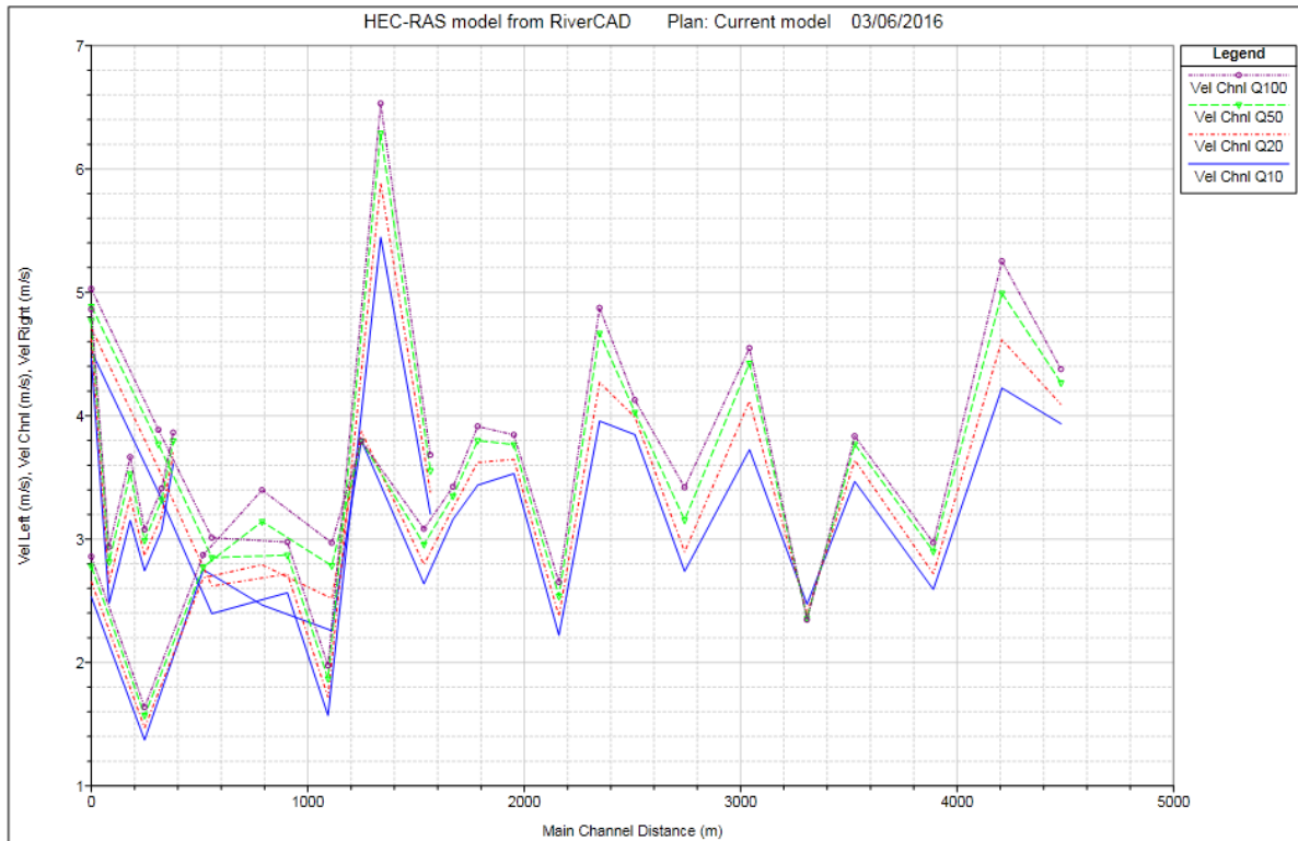
Fig.18 : Variation de la vitesse d'écoulement en fonction de la distance à partir de l'exutoire
