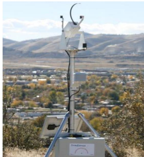
Figure 14 : Pyranomètre avec photodiode et anneau d'ombrage (RST) [19]
