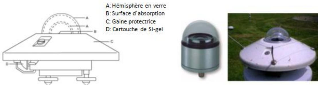
Figure 9 : Le pyranomètre à thermopile [19]
