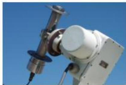
Figure 11 : Le pyréliomètre du rayonnement solaire direct
