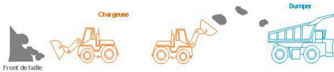
Figure 5 : Extraction et transport de la matière première.
