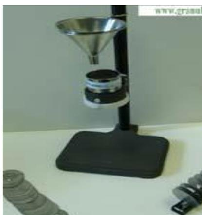
figure 9 : entonnoir pour mesure de coulabilité
