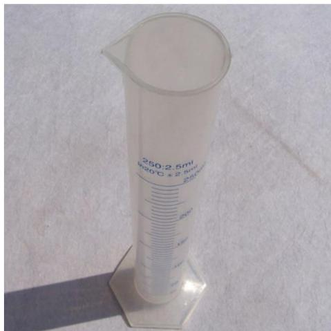
Figure 7 : éprouvette 250 ml pour mesuré la densité
