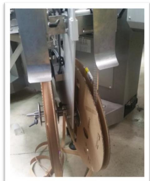
Figure 26 : support terminal après l'application du SMED
