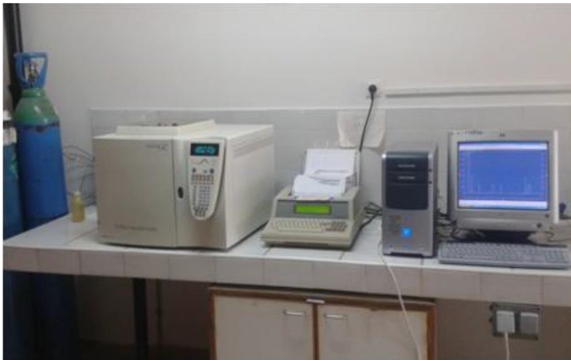
Photo 1. Chromatographe en phase gazeuse couplée à un détecteur à ionisation de flamme et un détecteur olfactif (GC-FID-O).
