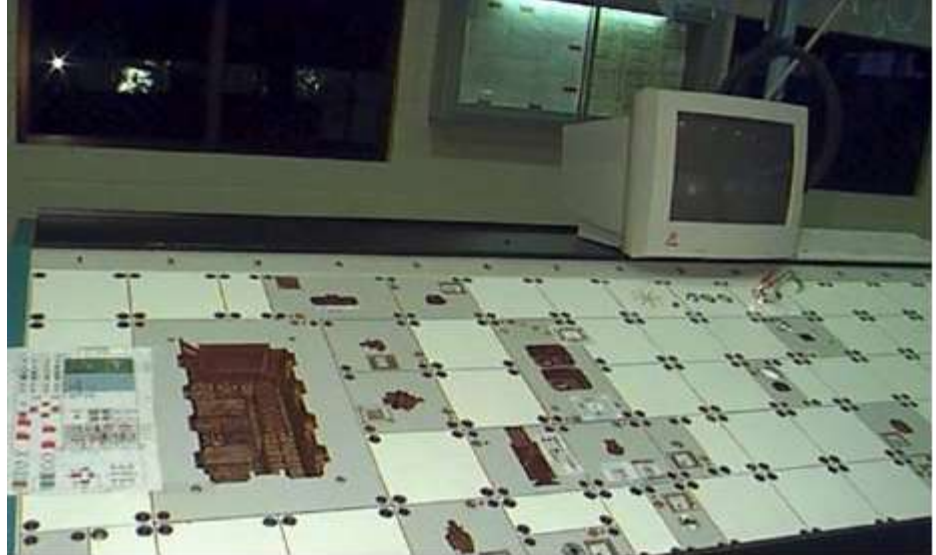
Figure 13: Table du test électrique
