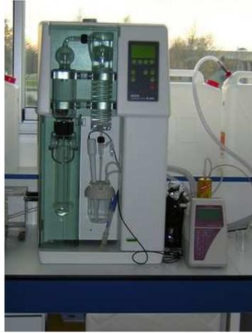
**Figure2 :l'appareil de distillation**
