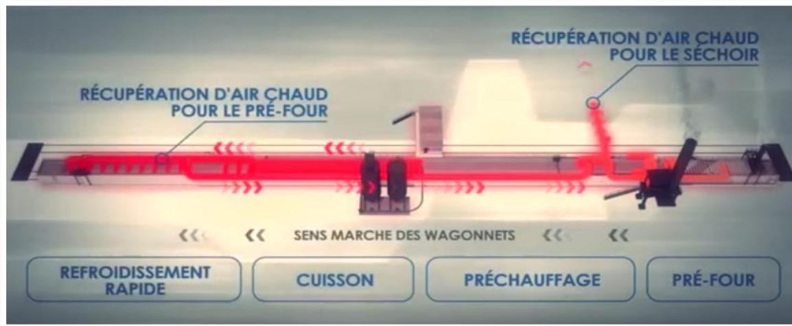
Figure 15: schéma simplifié du Four tunnel
