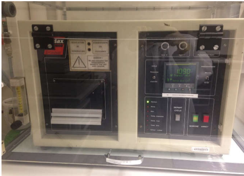
Figure 6: L'équipement du four à recuit rapide au sein de l'INL
