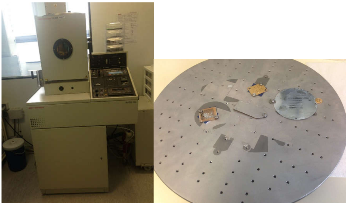
Figure 8 : Equipement d'évaporation par canon d'électrons ainsi que les masques utilisés
