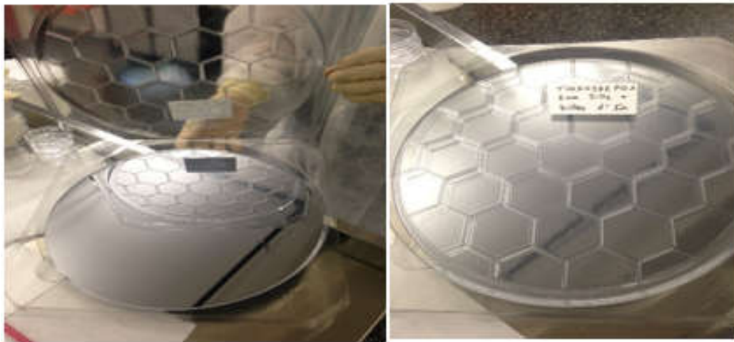
Figure 15: Nouvelles plaques constituées de : Silicium + 2nm de SiO 2 + nanostructures d'indium
