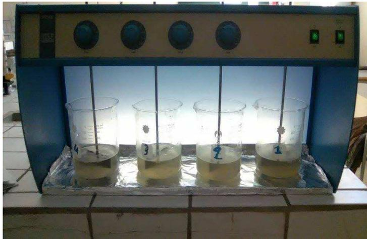
Figure 10 : Appareil JAR TEST
