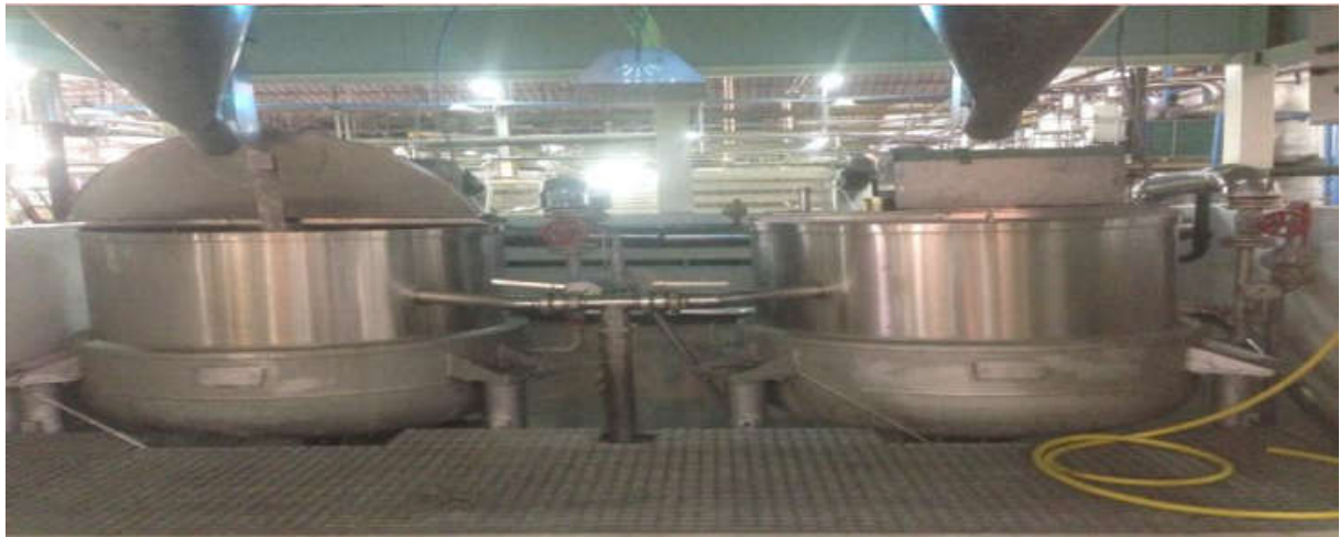
Figure N°5 :Boule en inox servant pour la précuisson
