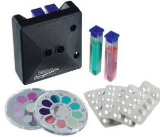
Figure 4 : Comparateur et pastilles de DPD
