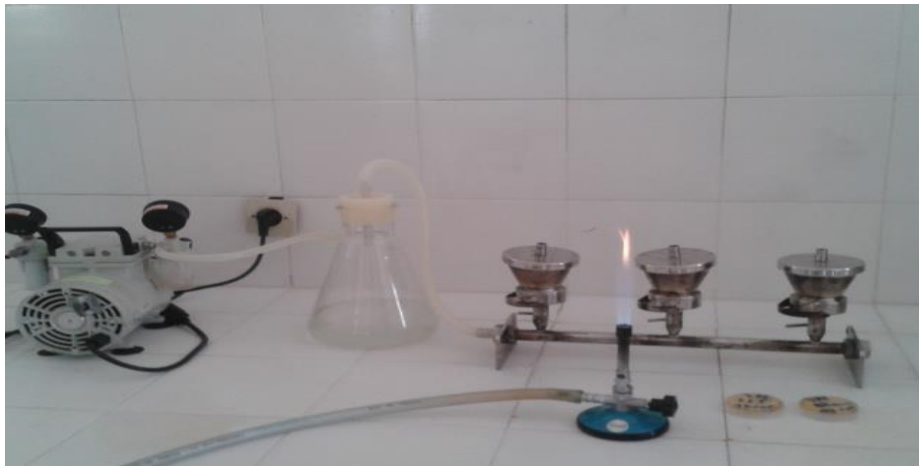
Figure14 : la méthode de filtration sur membrane
