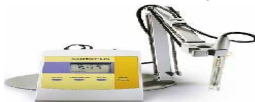
**Figure 4 : l'appareil de pH- mètre**
