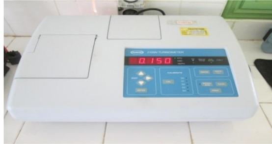
Figure 7: turbidimètre
