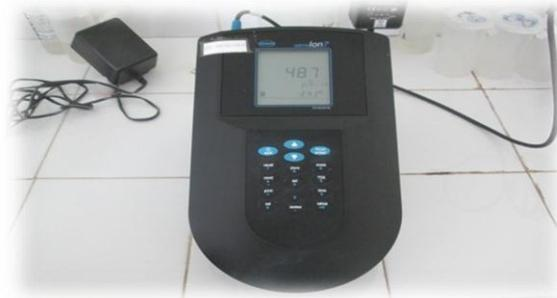
Figure 8: conductimètre
