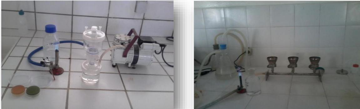
Figure 9 : Appareils de filtration sur membrane
