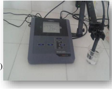
Figure 13:un conductimètre
