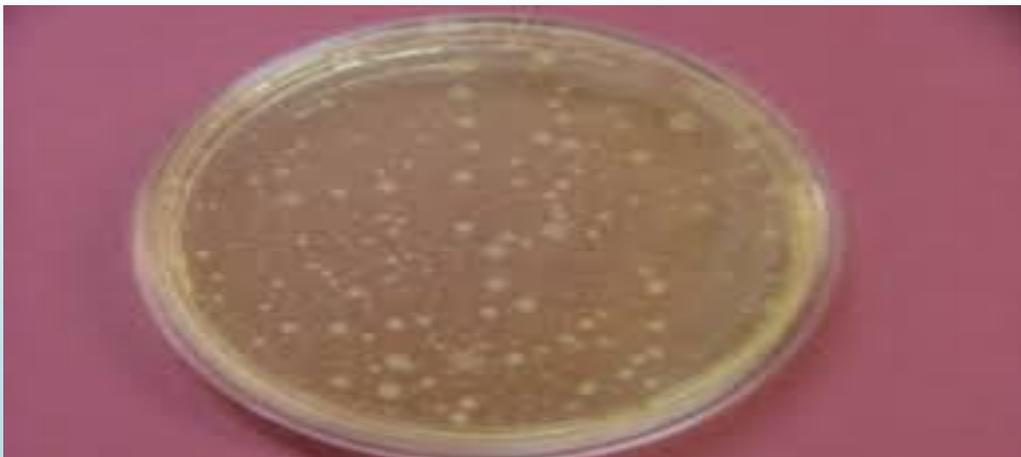
Figure 15 : la méthode d'analyse des MO revivifiables dans l'eau traitée (NM ISO 6222 année 2006)
