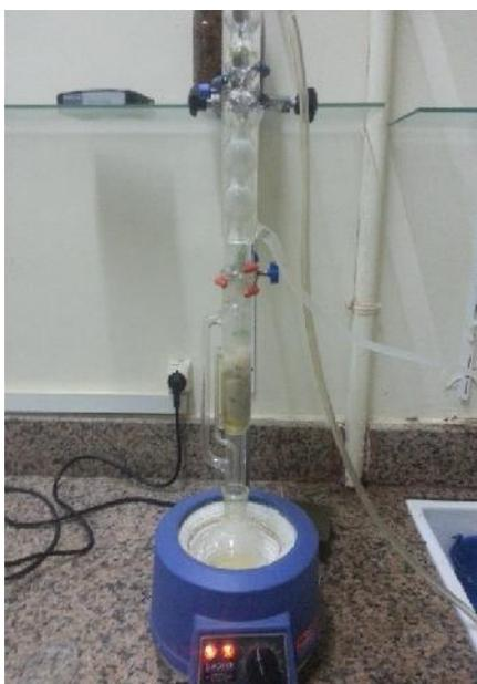
**Figure 3 :** Extraction par Soxhlet
