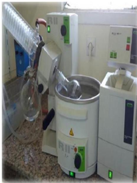
**Figure 4 :** Evaporation du solvant par Rotavapor
