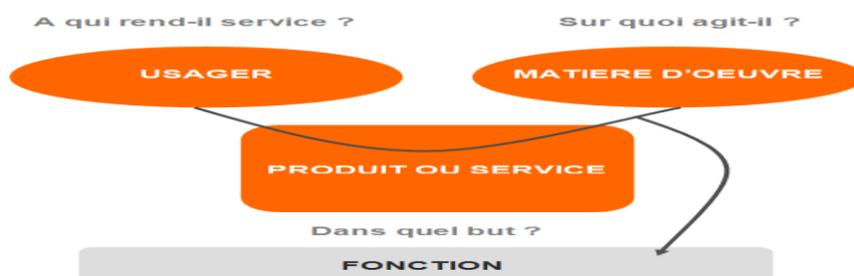
**Figure 2.1** : Diagramme bête à cornes
