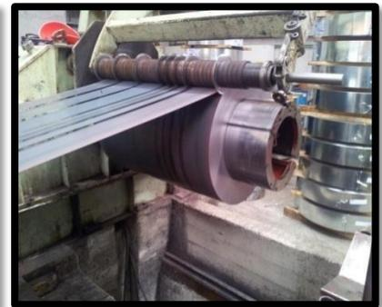
**Figure I.8** : Enroulement des feuillards produit
