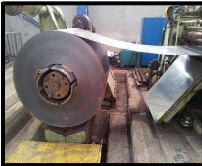
**Figure I.6** : Déroulement de la bobine à refendre
