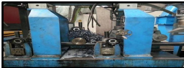
**Figure I.18:** Raclage cordant extérieur de soudure
