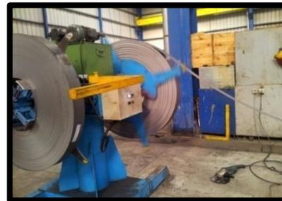
Figure I.11 : Feuillard déposé sur l'axe du dérouleur-machine tube 1
