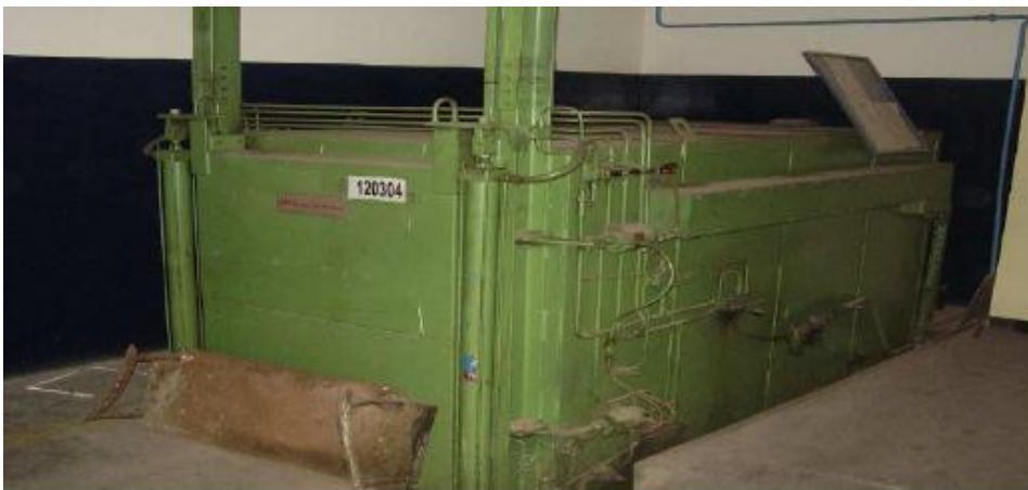
Figure 9 : Four de stabilisation
