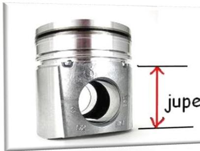
L'état de surface de la jupe est important pour assurer une bonne lubrification, parfois un traitement de surface peut être appliqué sur le piston ou uniquement sur la jupe, qui prendrons alors une coloration gris foncé ou noir due à une couche de carbonate de soude ou à une couche de graphite.
