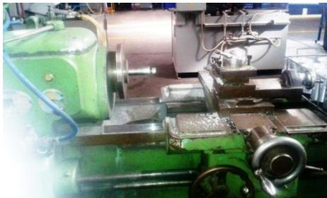
Machine pour usiner les gorges, circlips et chanfreins
