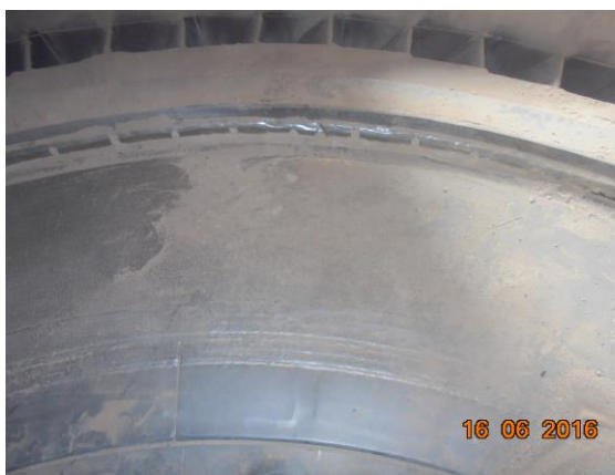
Figure 25 : Usure de la piste
