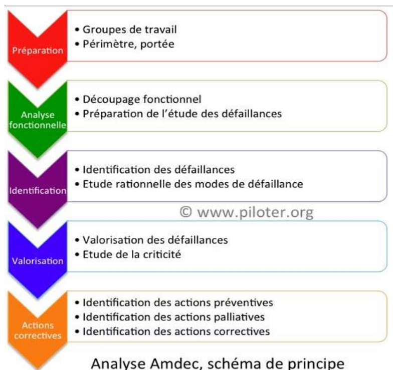
Figure 4 : Schéma du principe de l'AMDEC
