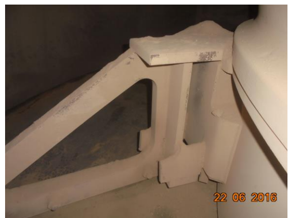
Figure 26 : Cisaillement du racleur
