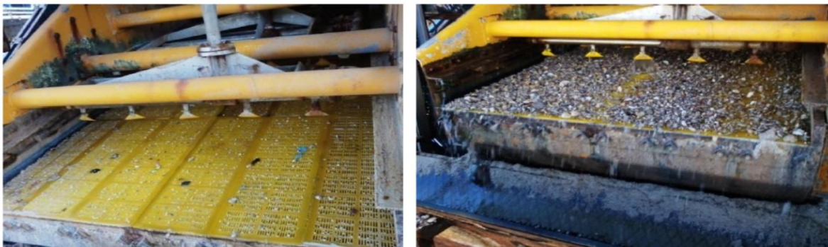
Figure 21 :Phénomène de goujonnage & Bouchage des buses d'arrosage
