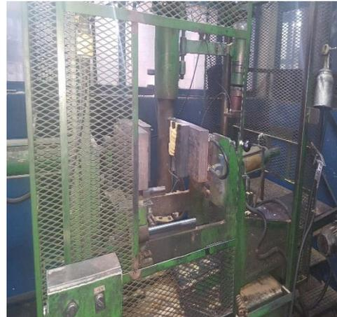
**Figure 10. La machine boîte à noyau**
