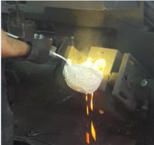
**Figure 11. On verse le laiton dans le moule**
