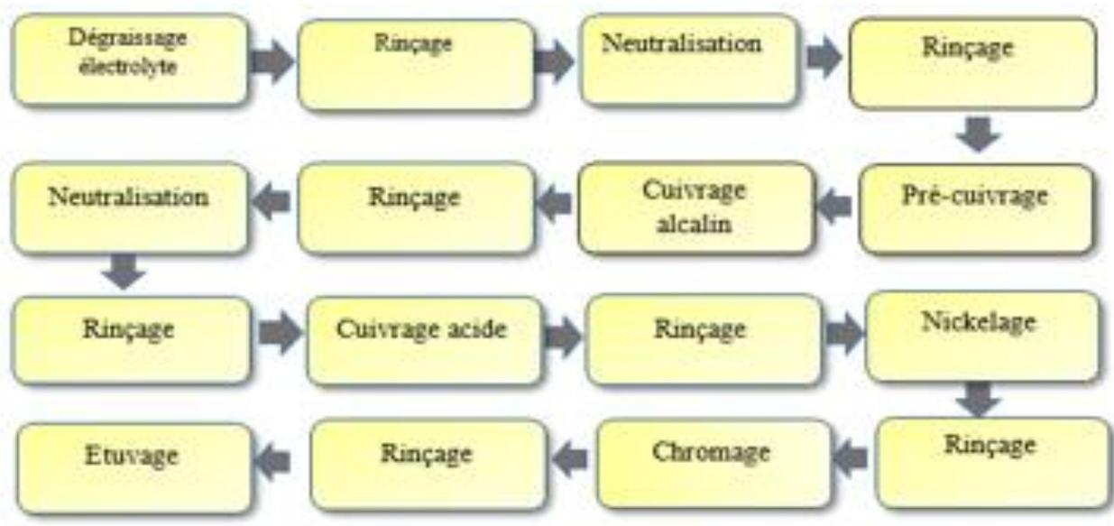
**Figure 20. Processus de traitement de surface des poignées en Zamak**
