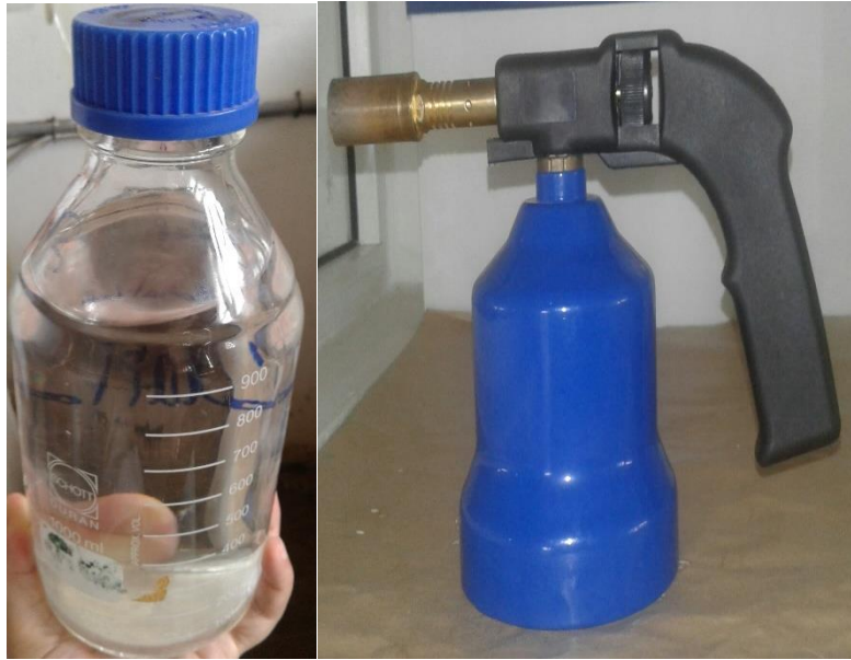
Figure 7 : Flacon stérilisé-Lampe à souder portative au gaz
