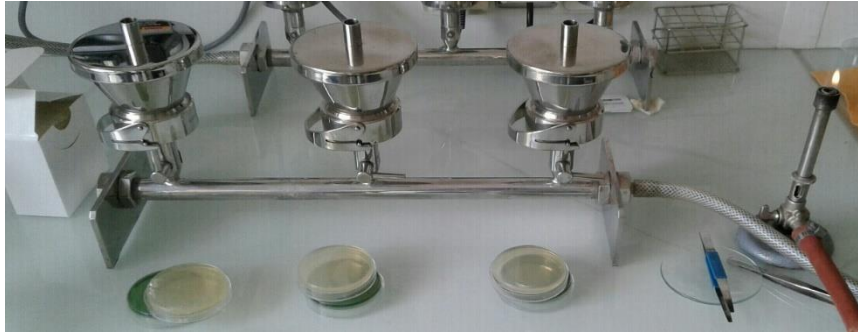
Figure 15 : Filtration sur membrane
