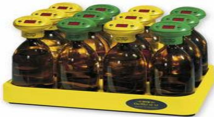
Figure 19 : Oxitop (Appareil pour mesurer la DBO<sub>5</sub>)
