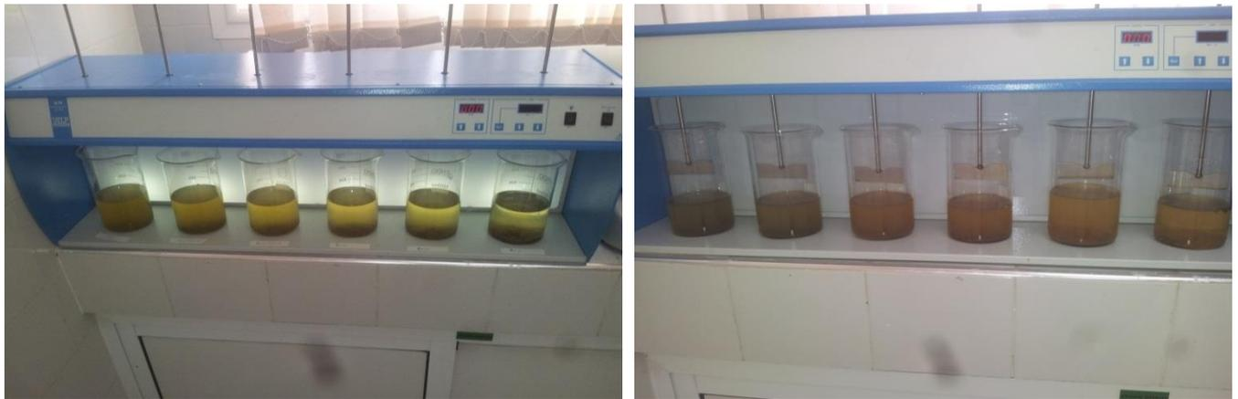
Figure 14 : Essai de coagulation avec Pax 18/ Sulfate ferrique
