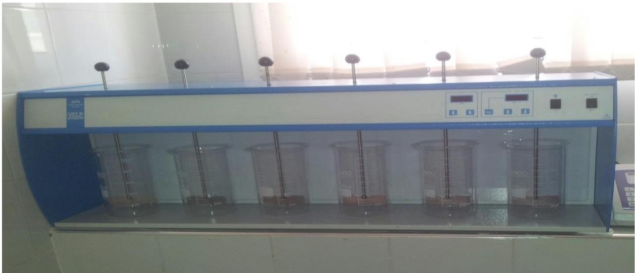
Figure 13 : Dispositif expérimental de l'essai de coagulation (Jar-test)
