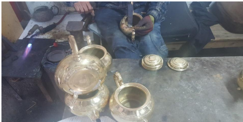
Photo 6 : soudure par étain
