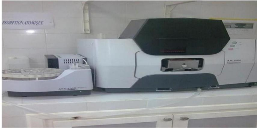
Figure 10 : Appareil d'absorption atomique
