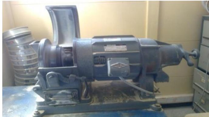
**Figure 14 : Broyeur à disque rotatif**
