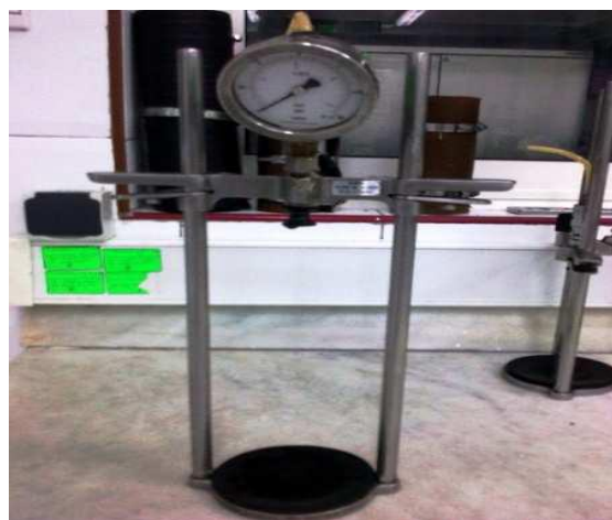
Photo 10 : Zahm munie d'un manomètre
