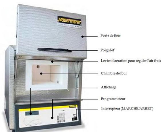
Ces fours sont faits de moufles en céramique enveloppés extérieurement par l'élément chauffant. L'intérieur de la chambre de chauffe reste totalement libre, sans encombrement des résistances.
