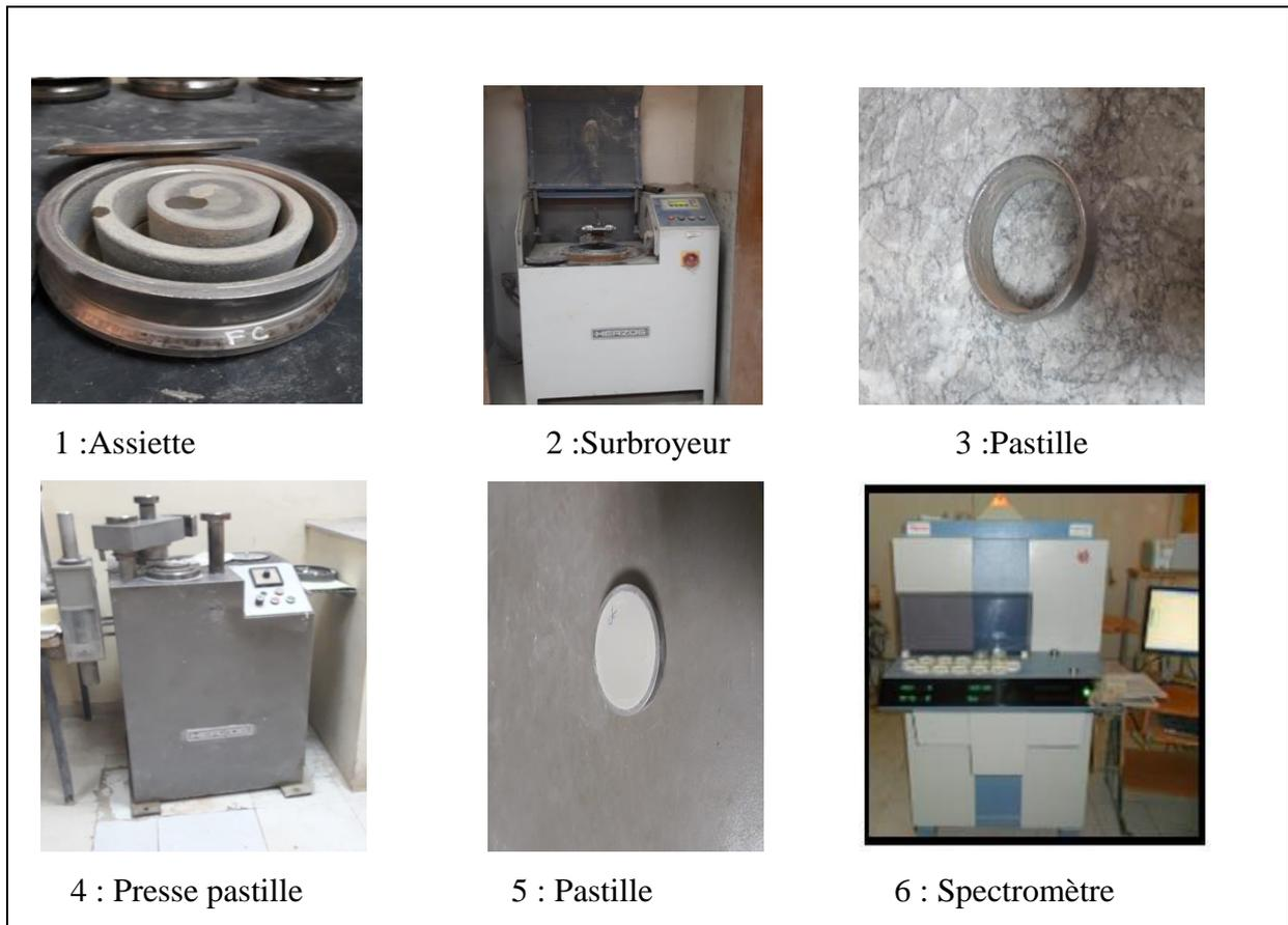
Fig 16 : Préparation et analyse des échantillons dans le spectromètre.
