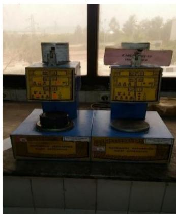
L'essai de prise par l'appareil de VICAT est composé essentiellement d'un piston vertical, muni à son sommet d'un plateau destiné à recevoir une charge amovible ou éventuellement des poids et portant un curseur se déplaçant devant une graduation à sa partie inférieure à chaque 10 min afin de déterminer le temps au bout duquel le ciment commence à durcir. On distingue 2 phases : Prise Initiale et Finale.
