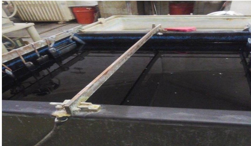
Figure 5 : Image du Bain du Cuivrage Acide
