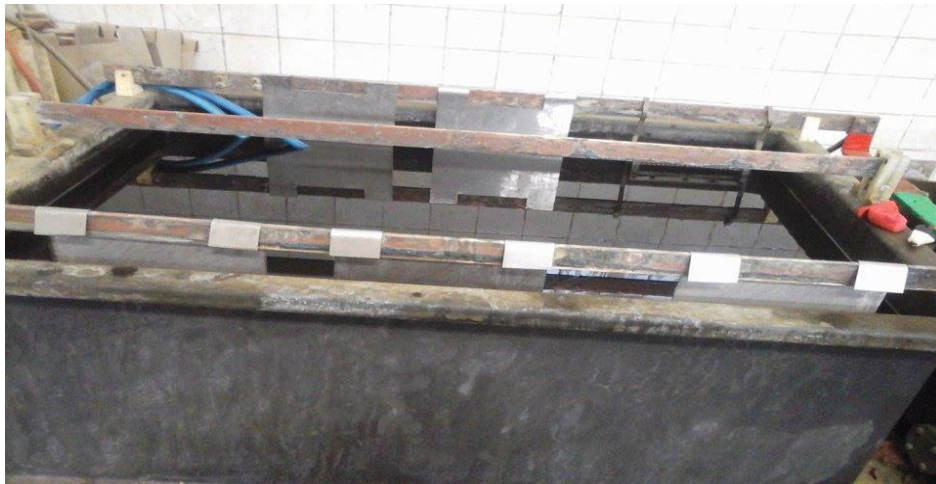
Figure 9 : Image du Bain d'Argentage
