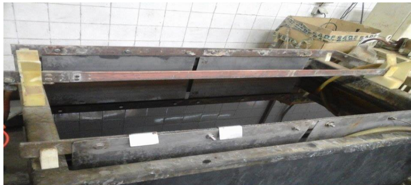
Figure 8 : Image du Bain de Pré-argentage
