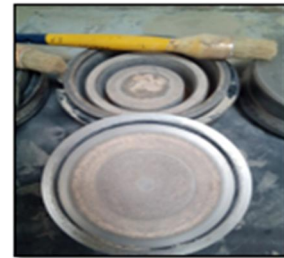
2-introduire l'échantillon dans le bol en carbure de tungstène
