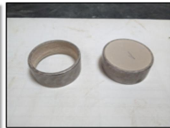
4- mettre 10g de l'échantillon, récupérée dans un moule en acier puis préparer une pastille dans une presse à pastille
