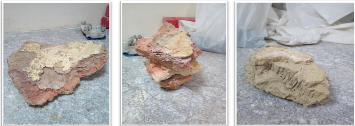
Fig. 26 : échantillon de matière accumulé provoquant par la suite un bouchage de cyclones
