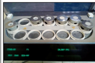
6-Le porte échantillon contenant la pastille est place dans le compartiment de mesure du spectromètre
