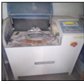
3-l'assiette est introduite dans un sur-broyeur pendant 3 min
