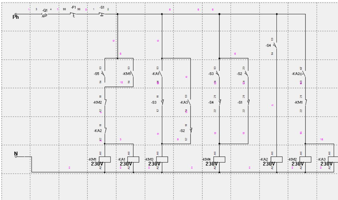
**Figure 17: Schéma de commande de la porte automatique**
