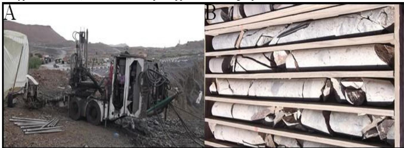
**Figure 42:** A) machine de sondage (Sondeuse LY44), B) caisses à carotté de sondage SFC2302/-9°.
