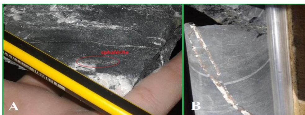
Figure 18: A) : La sphalérite en masse concentrée au niveau de la dolomie à la structure F0S-Niveau 1328, B) : Des petites veinules de dolomie rose très riche en sphalérite.
