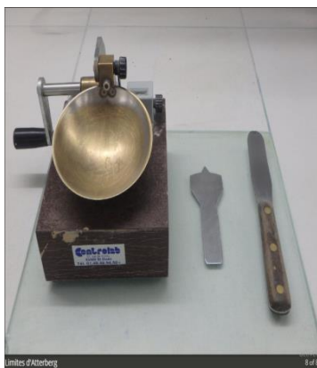
Figure 7 : 1-cas grande, 2- lavage de l'échantillon, 3- étalement de l'échantillon, 4-WL et WP prêtent à mesuré leur teneur en eau.
