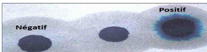
Figure 8 : résultat de l'essai de valeur de bleu de méthylène
