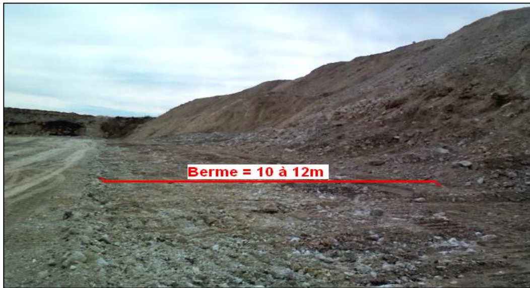
Photo 24 : Position d'une berme dans L'EZCS pendant le stade de décapage.
