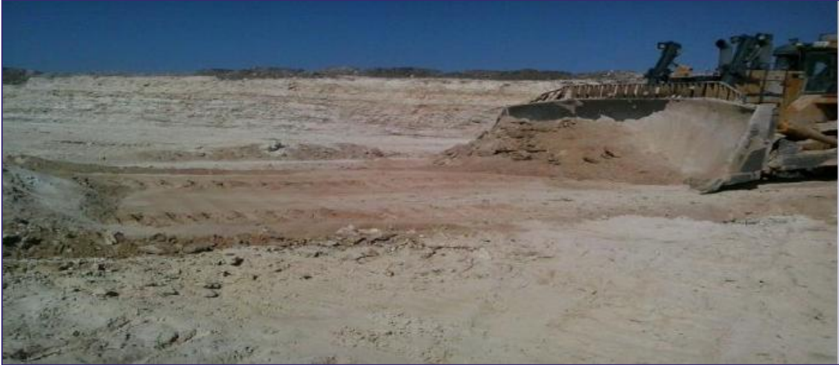
Photo 22 : Nettoyage de la couche phosphatée par Bull D11.
