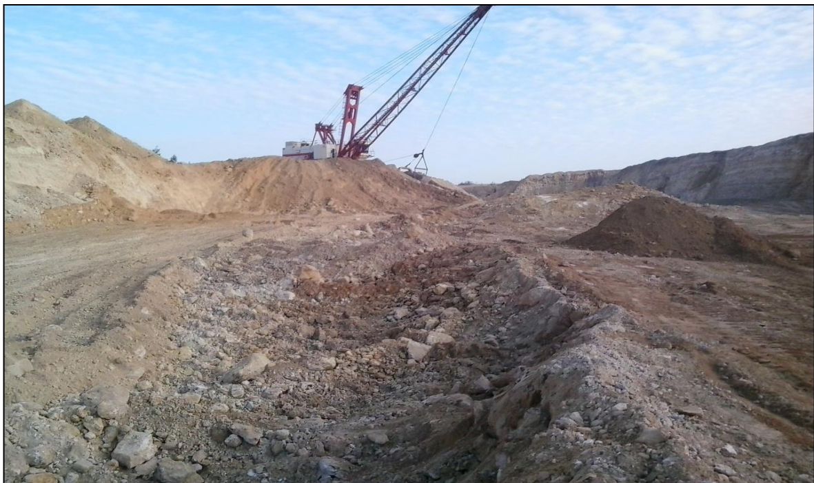
Photo 30 : Exemple d'une dragline qui fait la troisième position
