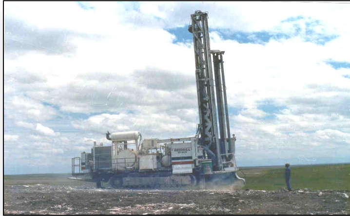
Photo 3 : Sondeuse rotative reeddrill SK 60 II - DIESEL
