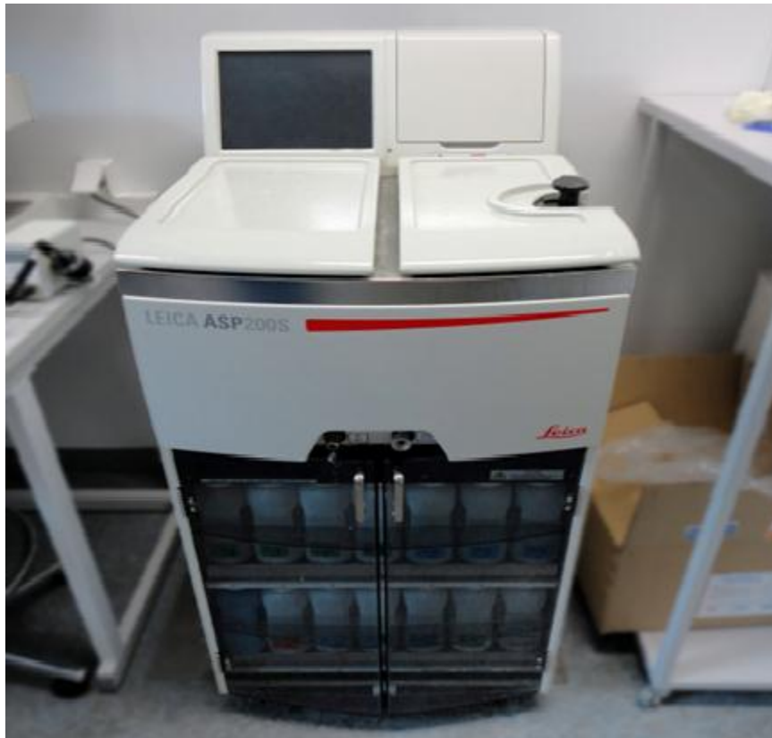
Figure 8: Automate permettant l'inclusion des échantillons fixés dans la paraffine après déshydratation [64].
