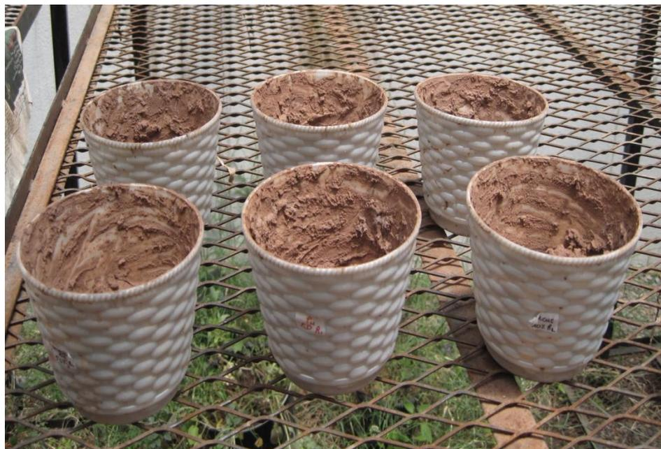
**Figure 4 :** Essai des sols traités avec les différents extraits algaux.
