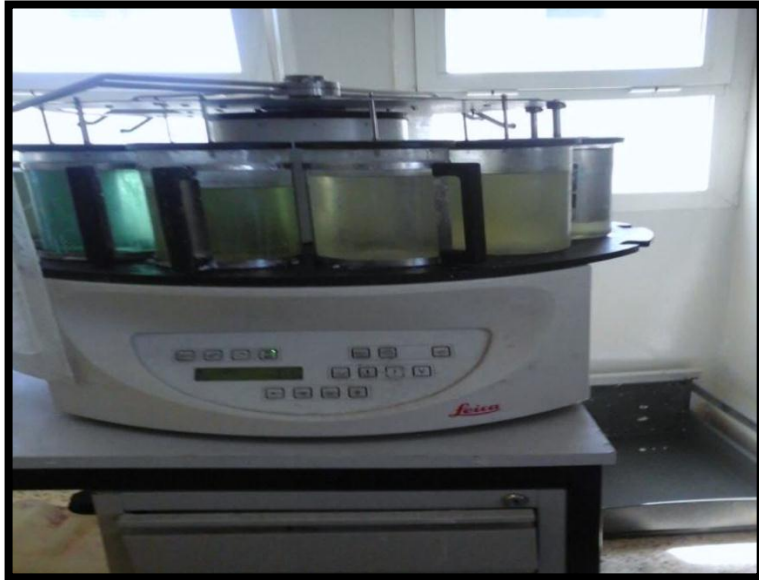
Figure 8 : Histokinette, Automate permettant l'inclusion des échantillons fixés dans de la paraffine après déshydratation.
