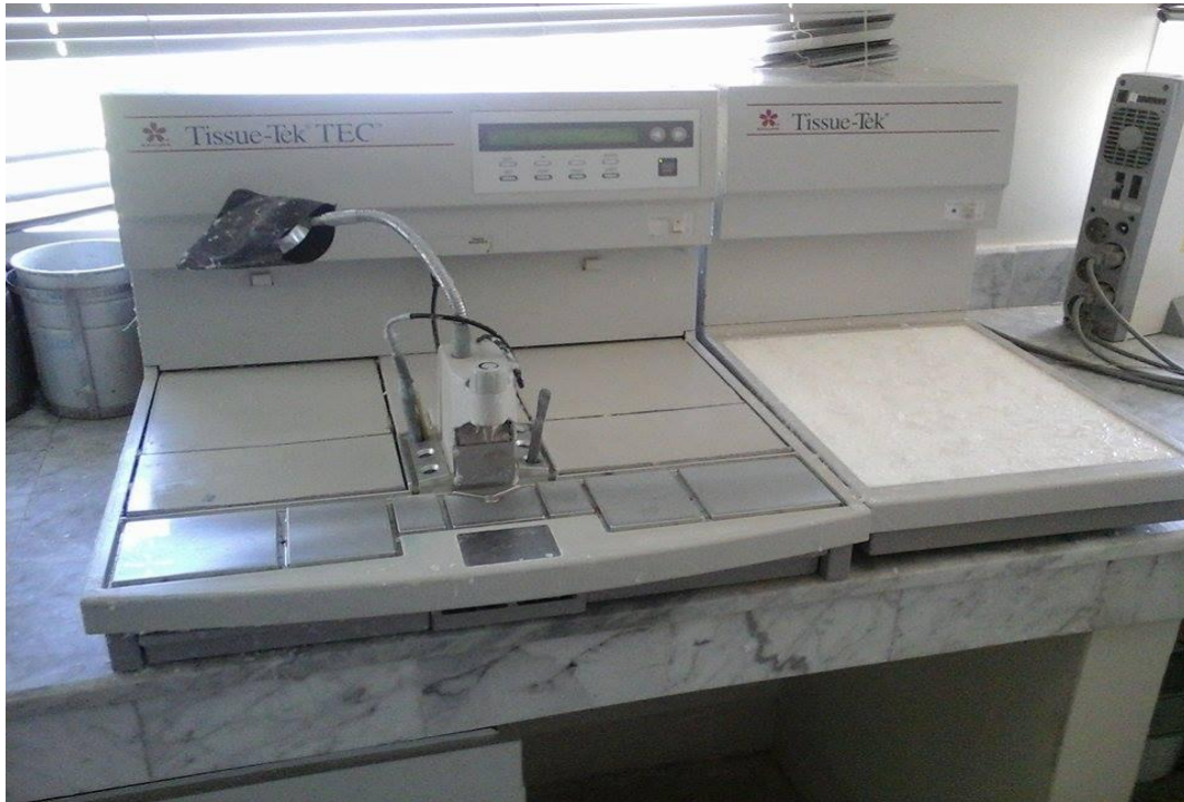
Figure 7 : Appareil d'inclusion dans la paraffine
