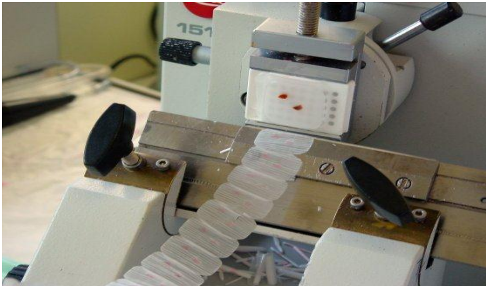
Figure 9 : Coupe au microtome
