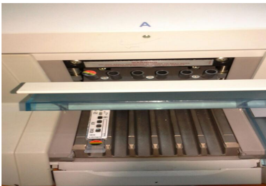
Figure 9 : La disposition de cône et la cartouche dans le compartiment de L'automate
