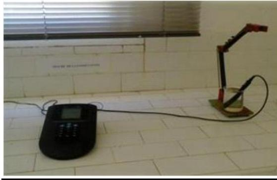
Figure 7 : Appareil de la conductivité
