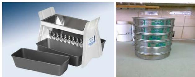
Figure III.1 : Diviseur a riffle et la série de tamis.
