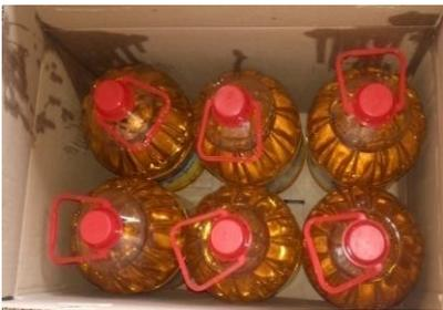
Pour le problème d'étanchéité des bouchons il suffit une simple intervention auprès de responsable de la boucheuse qui consiste à un réglage manuel de la boucheuse qui doit être fait après chaque changement de produit pour les deux lignes celle de (½ L ,1L) et (2L,5L).
