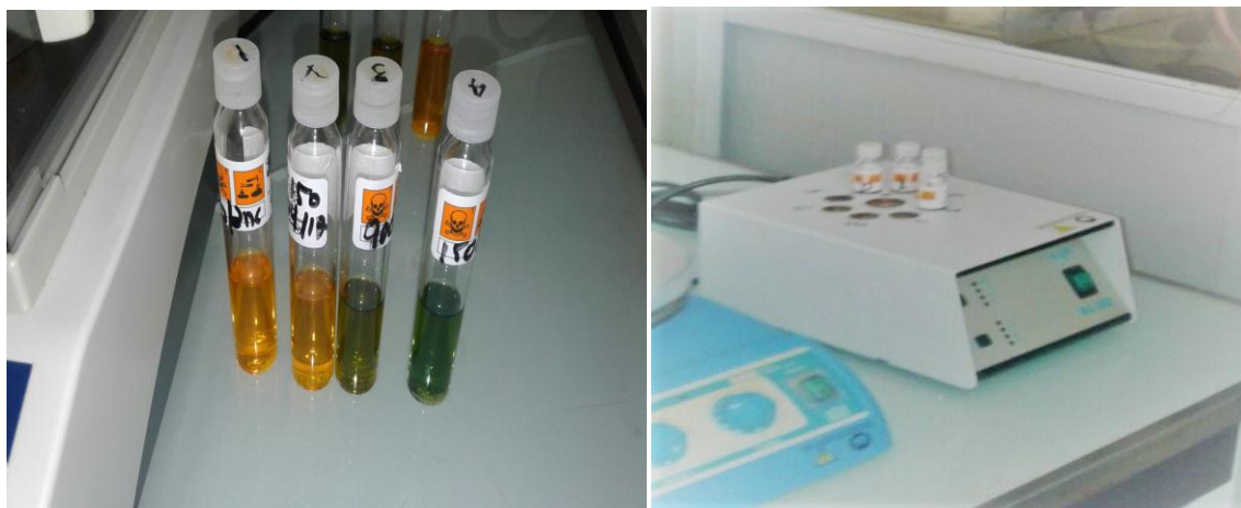
Image 15 : préparation des étalons de la DCO
