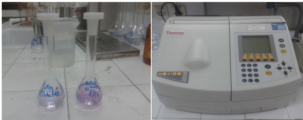
Image 17 : Dosage des nitrates par spectrophotométrie
