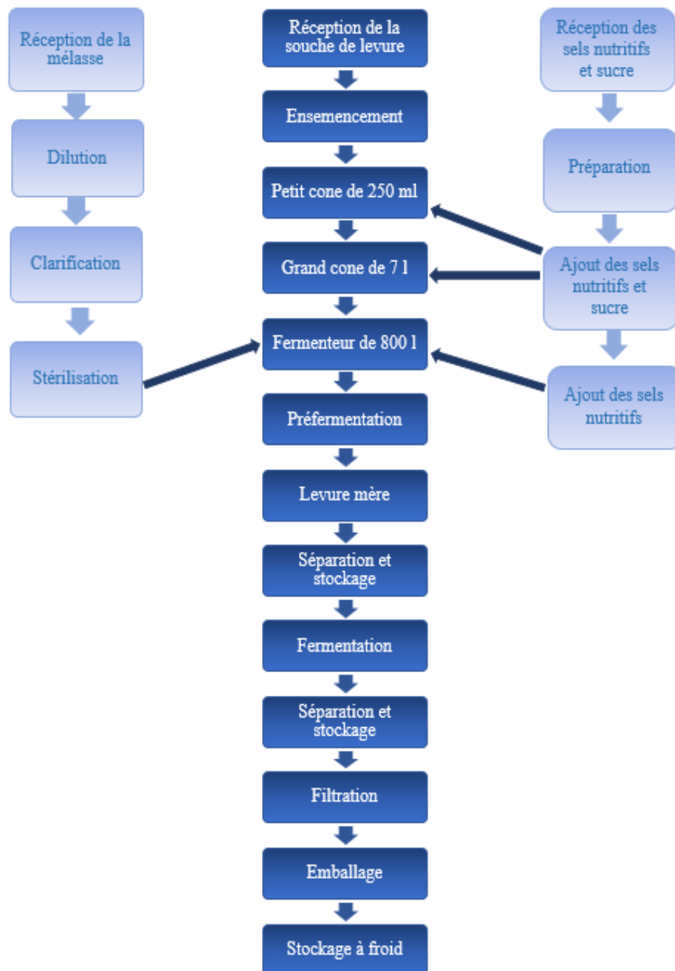
Figure 10 : Diagramme de fabrication de la levure fraîche
