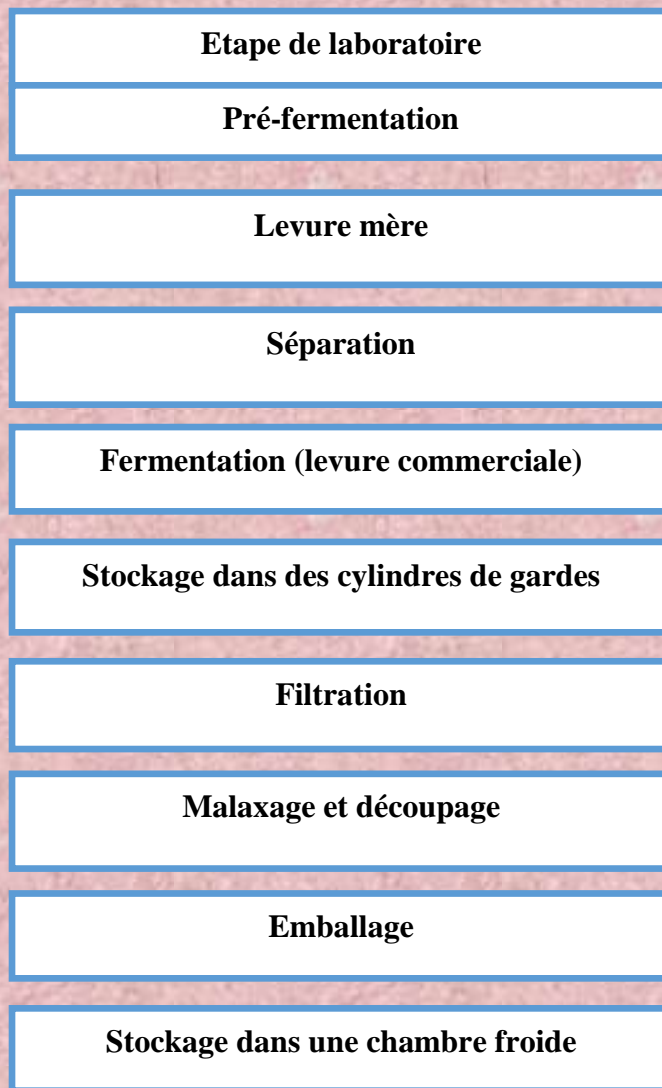
Figure 4: diagramme de fabrication de levure de fraîche
