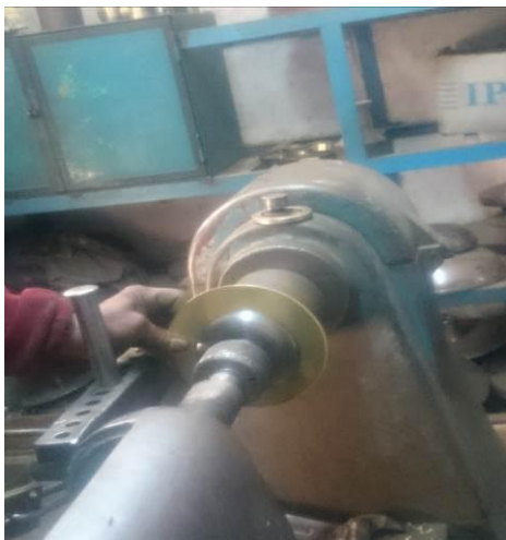
Image 5 : pièce au cours de déformation
