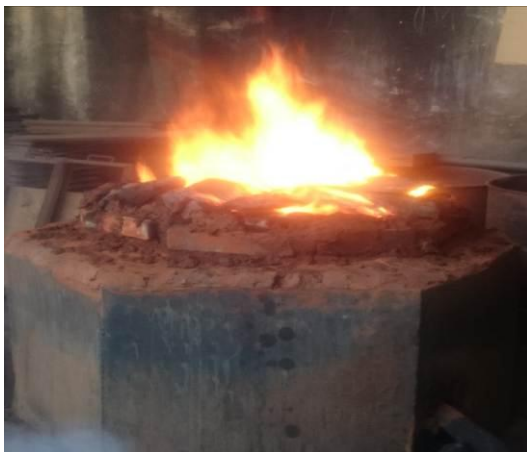
Image 8 : fendage des chutes de laiton particulier
