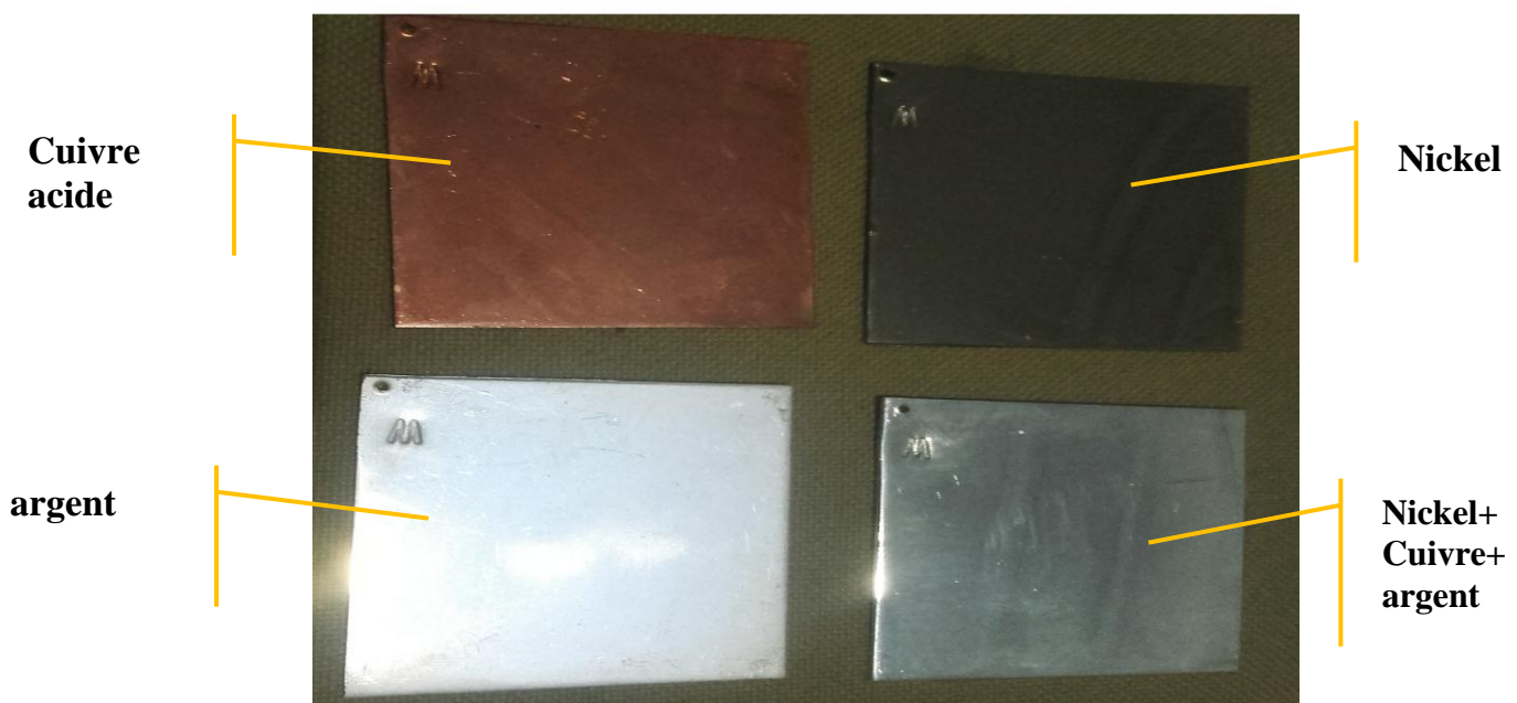
Image 22 : les différentes plaques du laiton traitées
